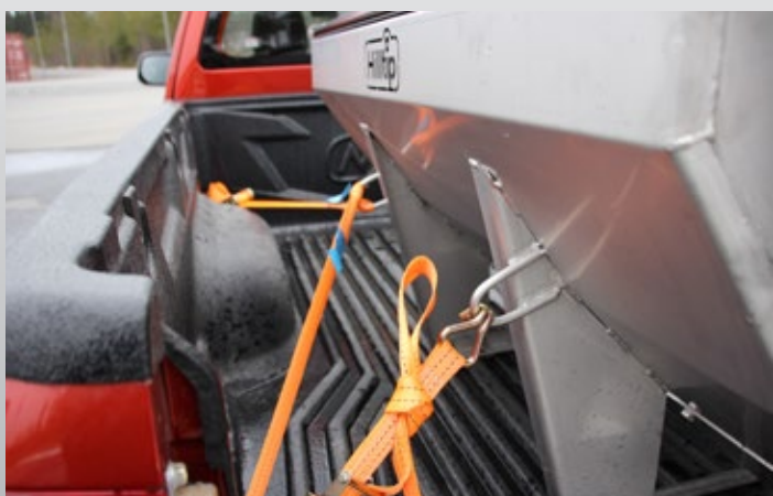
Oesen zur Befestigung des Streuers auf dem Trägerfahrzeug
